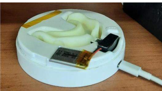
Рис 3. Прототип умной капы
